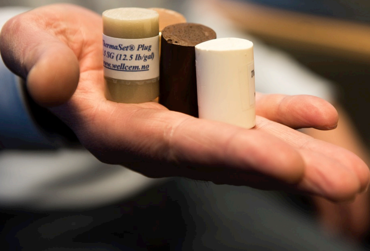
Wellcem leverer produktet ThermaSet som benyttes til tetting av lekkasjer i oljebørner. Foto: Wellcem
