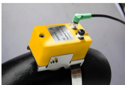
En PipeMonit SWARM S1 ultralydsensor inngår i en gruppe med flere sensorer som samarbeider om å bestemme korrosjonsrater for et topside eller landbasert rør.
